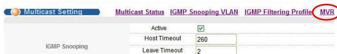
**步驟四：**請勾選 **Active** 啟用 MVR，並輸入其名稱，而在 **Multicast VLAN ID** 欄位請填入與在多點廣播路由器(Multicast Router)GS-4024 上的多媒體伺服器所在的 VLAN 相同。另外在 **Mode** 請選擇 **Dynamic**。
