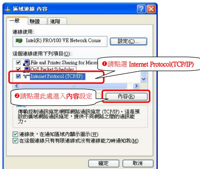
步驟五：請在 “Internet Protocol(TCP/IP) 內容” 的視窗點選 “自動取得 IP 位址” 與 “自動取得 DNS 伺服器位址”，完成後按下方的 “確定” 即可。
