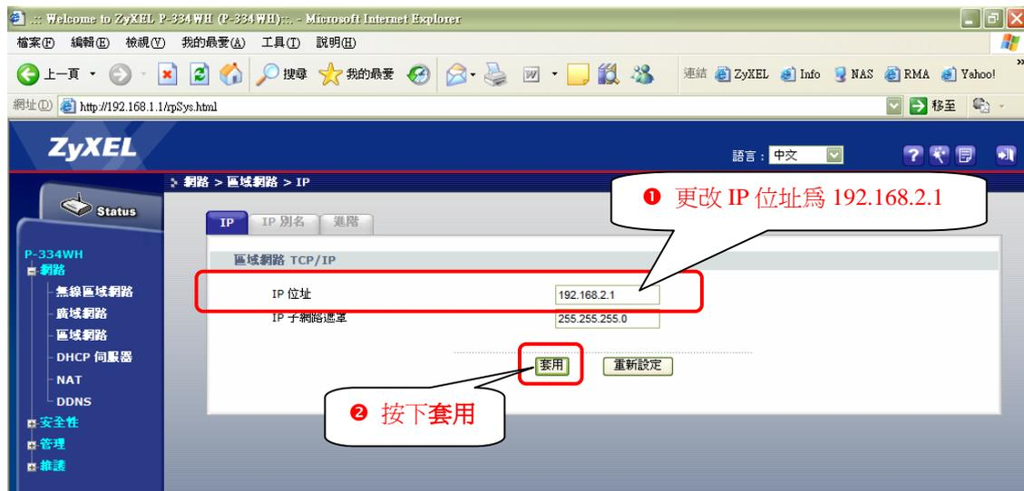
步驟十：修復 IP，IP 更新完成時，請依步驟五進行操作模式的轉換。
