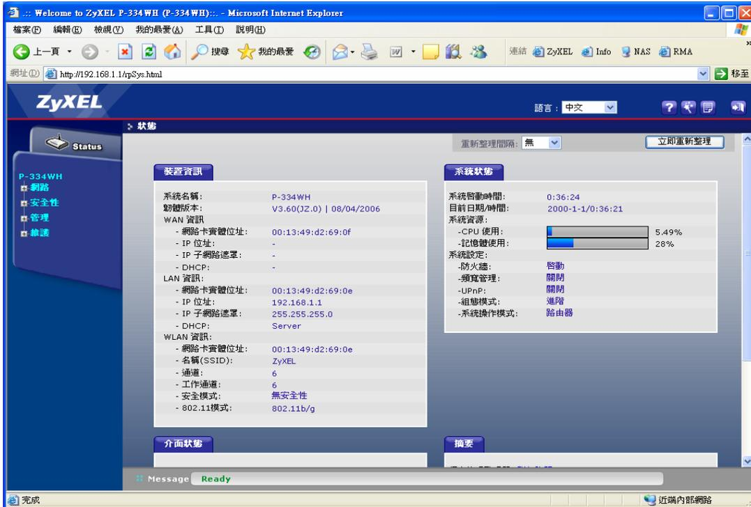
※ 在進行操作模式轉換前，請先確認您欲連結的基地台所發配的 IP 位址與 P-334WH 是否為相同網段，若為相同網段，建議您先參考**步驟九**，將 P-334WH 的網段變更，再進行系統操作模式的轉換。
