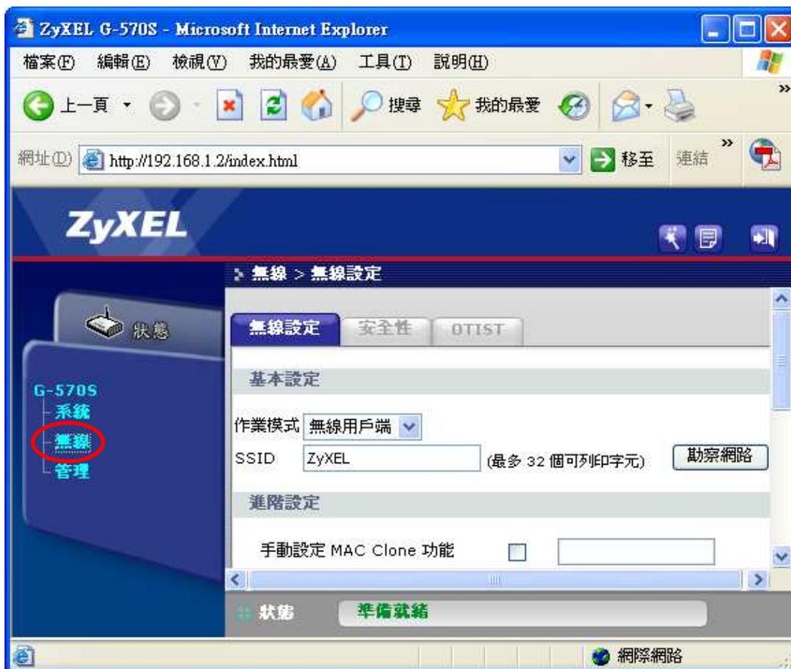
步驟八：請在作業模式選擇“無線用戶端”→請在 SSID 輸入您的另一台無線基地台的 SSID 名稱→請點選“套用”
