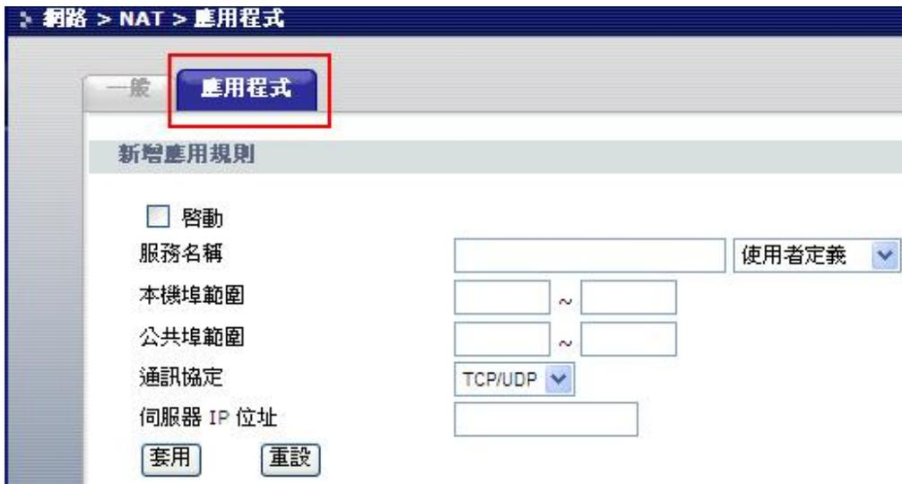
步驟五：伺服器架設於 NBG-416N 的 LAN 埠，皆需讓外部電腦透過 WAN 的 IP 位址進入 NBG-416N 底下存取伺服器，如下圖，將您建立的伺服器所在位址、開啟的埠號及服務名稱，輸入在欄位中，填寫完畢並勾起“啟動”→點選“套用”
