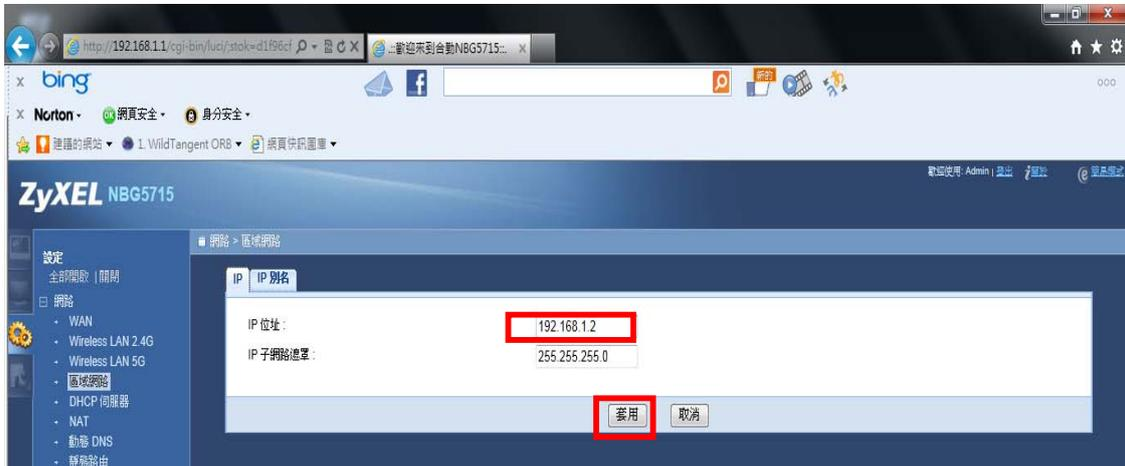
步驟七：以上設定完畢後，將前端 IP 分享器設備的 LAN Port 的線路接線至 NBG5715 的 LAN Port 上即可！
