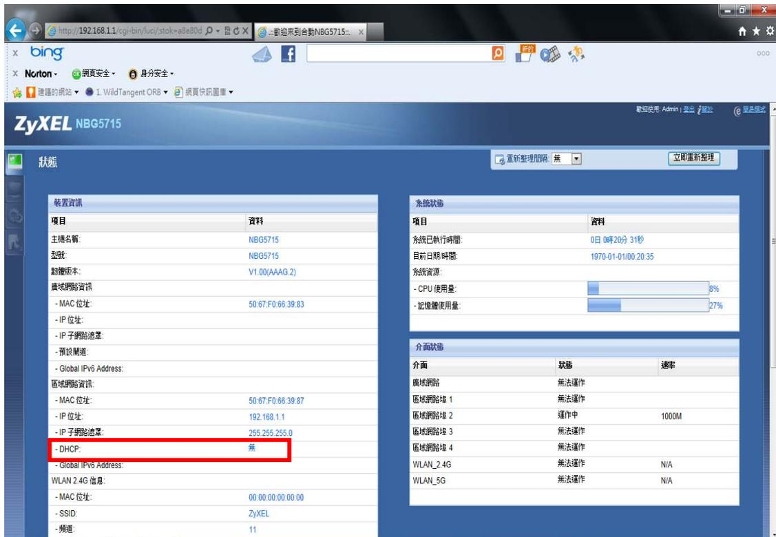
步驟六：將您的 NBG5715 的 IP 位址與上端 IP 分享器的 IP 位址錯開(此範例前端分享器 IP 位址:192.168.1.1,因此 NBG5715 即設定為 192.168.1.2)。
