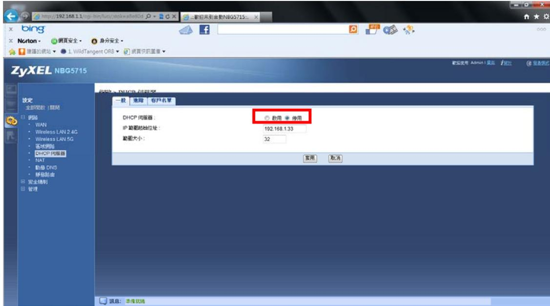
步驟五：套用完成後，煩請回到狀態頁面，確認 NBG5715 的 DHCP 已經關閉。
