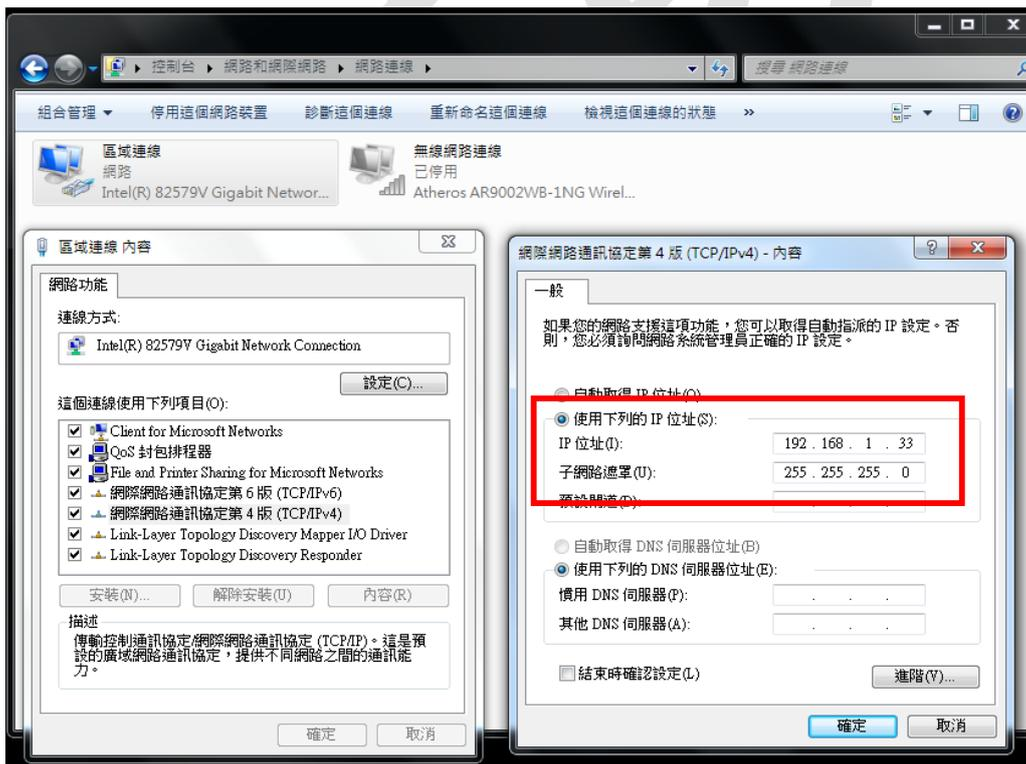
步驟二：電腦與 NBG5715 以實體網路線連線→在電腦上開啟一網頁，於網址處輸入 192.168.1.1，進入 NBG5715 設定畫面。
